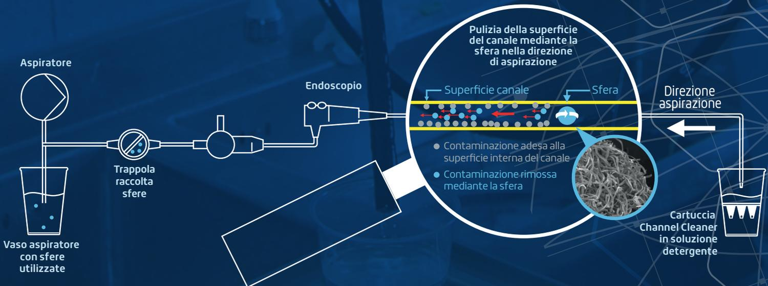
**Spazzolatura** dei canali **efficace, sicura, ripetibile e veloce**, grazie a **microsfere** costituite da più di un **milione** di **fibre** delle dimensioni di pochi **micron**.
